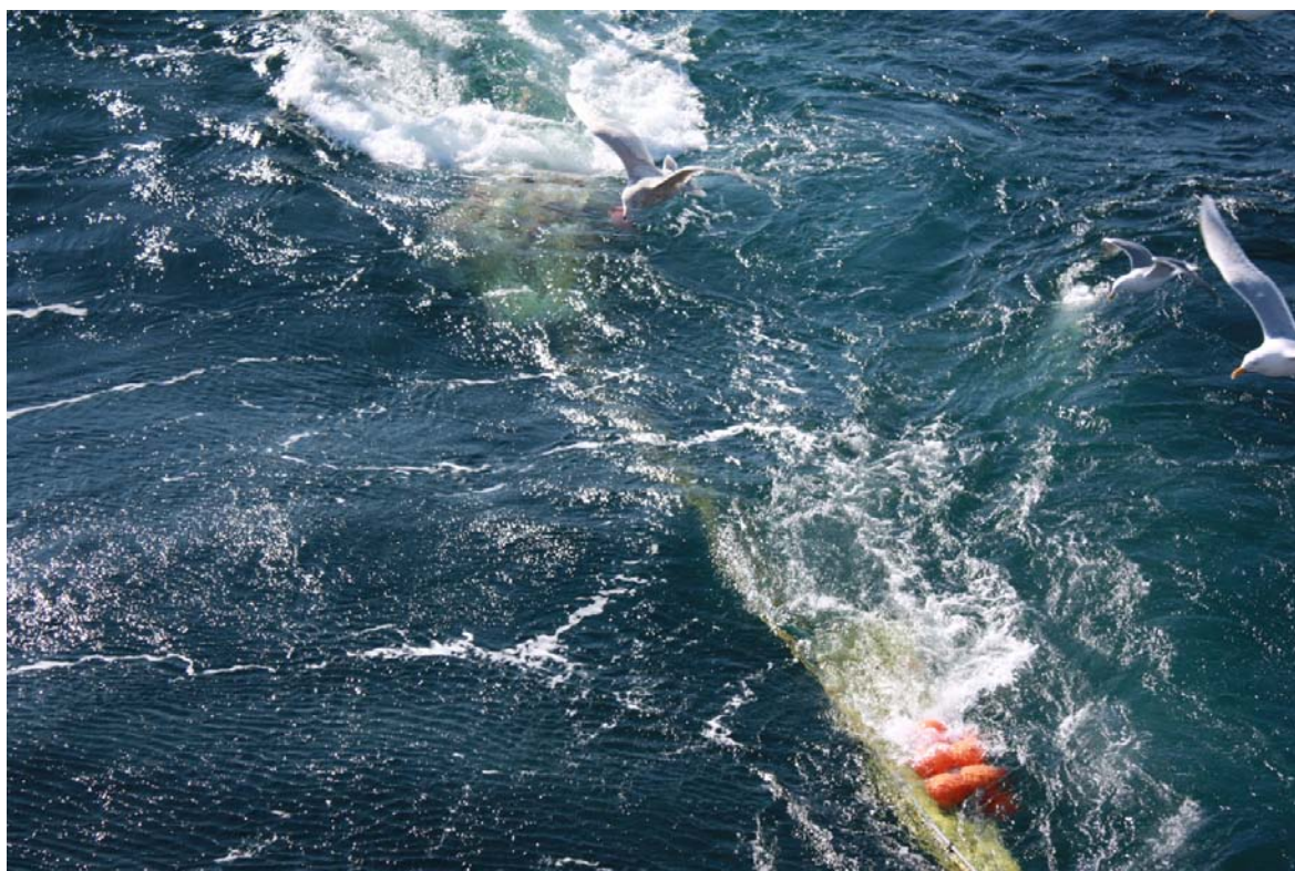
Bilde 6: Inhalings prosess. Sekken er allerede på overflaten
